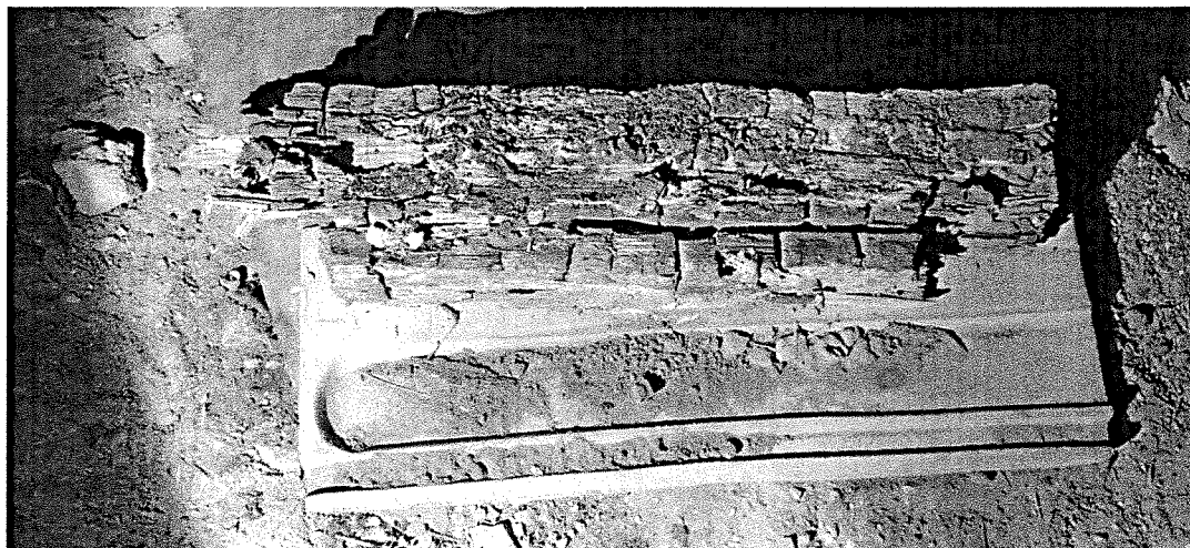
10. kép gomba által teljesen tönkretett sárgերenda darab
